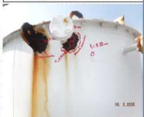
Pic. No. 6 Location : ExpansionTank no. 01GHC10BB001 Description : พบบริเวณรอยร้าว และเกิด Severe corrosion บนถังวัด ความหนาที่ shell 2in ได้ค่าเฉลี่ย 3.76 mm จากค่าเดิมที่ 6.35 mm
